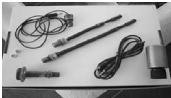
Figura 2. Micrófonos de Electret empotrados dentro de una bujía y otros elementos necesarios para capturar los sonidos dentro del motor.
