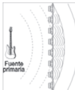
Figura 1. Array de altavoces (fuentes secundarias) sintetizando el campo acústico creado por una fuente primaria
