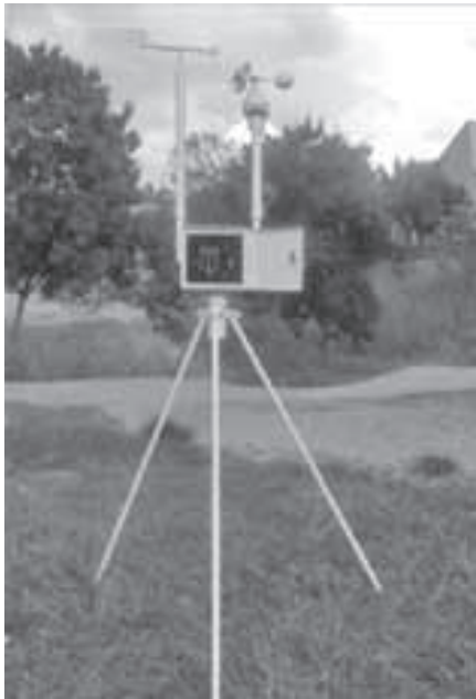
Fig. 2 Estructura estación meteorológica portátil.
