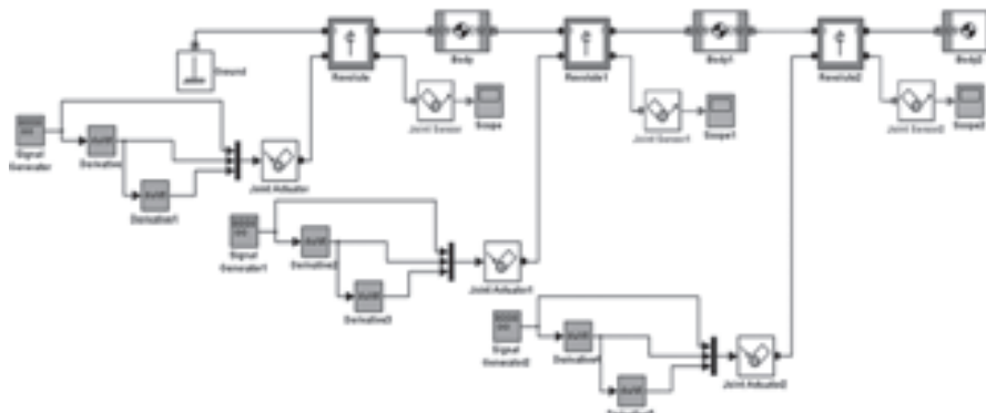
FIG. 3 Modelo dinámico de un manipulador implementado en Simulink
