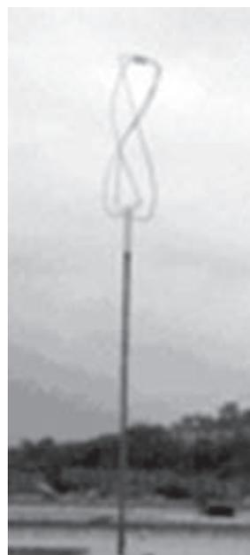
Esta clase de antena tiene una particularidad importante, posee una radiación con un diagrama de circularidad muy excelente, funciona como antena de recepción y de transmisión, y son antenas omnidireccionales.
