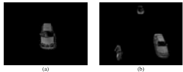
Figura 7. Sustracción del fondo estimado a un cuadro del video.
