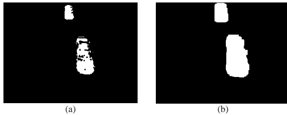
Figura 5. Obtención de la máscara de actualización: a) resultado del proceso de erosión y b) resultado del proceso de dilatación.
