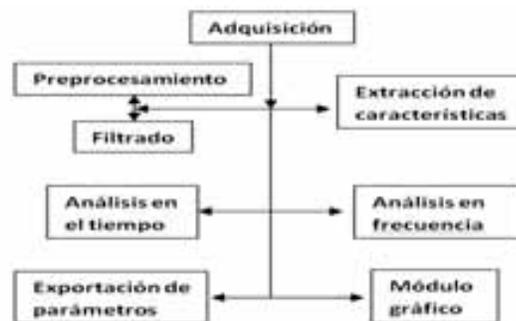
Fig.1 Diagrama de bloques SPRUA
