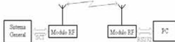
Fig. 12. Configuración de comunicación PC - Cohete
